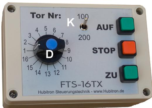
Das Tor kann nun mit den Tasten AUF, STOP, ZU bedient werden.
