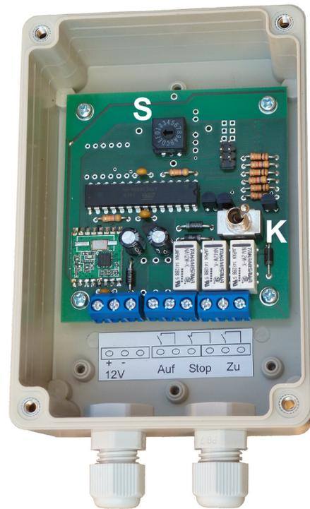
Die Schaltkontakte werden an den Klemmen Auf, Stop und Zu angeschlossen. Der Kontakt Stop ist als Öffner ausgeführt, Auf und Zu als Schließer.
